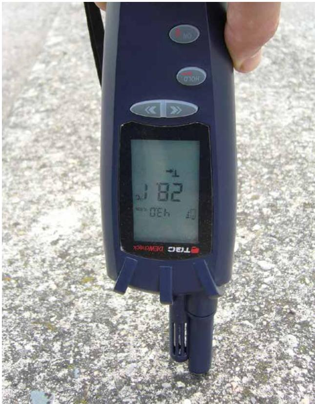
Messung der Bauteiltemperatur.
