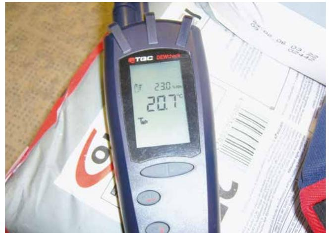
Messung der Lufttemperatur und der relativen Luftfeuchte.
