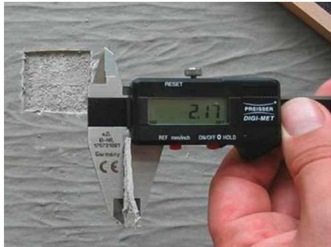
Die Schichtdickenmessung einer Ausbauprobe mittels Schieblehre.
