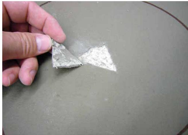
Herausgeschnittenes Abdichtungsstück zur Ermittlung der Schichtdicke.
