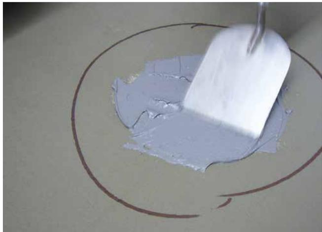
Verfüllen der Messstelle mit dem Verbundabdichtungsmaterial.
